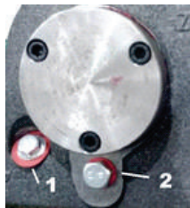
Рисунок 3 – Маслозаливная и сливная пробки
