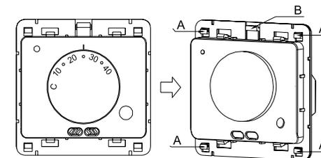
2. Отсоедините металлическую планку от терморегулятора, отщелкнув защелку сверху терморегулятора и потянув металлическую планку вниз.
