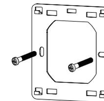
3. Закрепите металлическую планку на монтажной коробке.
