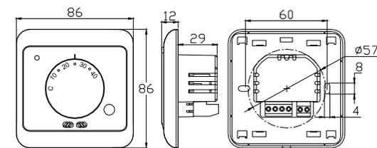
Размеры терморегулятора указаны в миллиметрах
