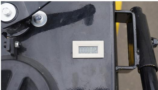
Рисунок 4. Счетчик моточасов
