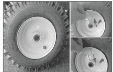
Установка шплинта на левом колесе шнека
